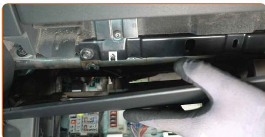
**6** Ta loss säkringsboxen och flytta den åt sidan.
