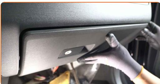
**18** Skruva i skruvarna som fäster handskfacket. Använd Torx T25. Använd hylsnyckel Nr8. Använd en spärrnyckel.
