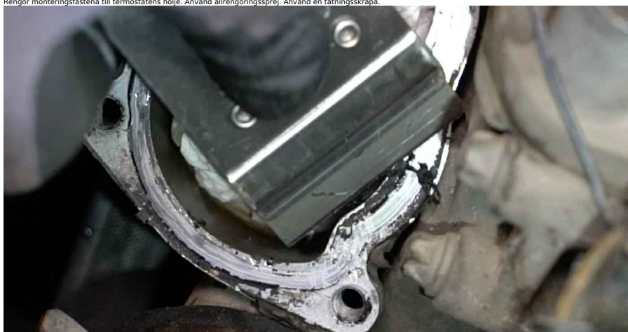
25 Montera den nya termostatsens hölje tillsammans med termostaten.
