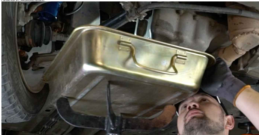
7 Lossa kylvätskeslangens klämma. Använd Clic-R-klammertänger.
