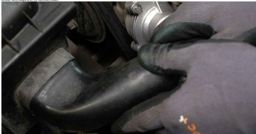
32 Fäst klämman på luftfiltrets insugs slang.
