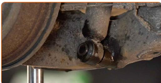
**10** Skruva loss övre fästelementet från stötdämparen. Använd hylsnyckel NrE20. Använd en trycknyckel.
