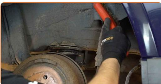
**7** Stötta upp stängan. Använd en hydraulisk domkraft.
