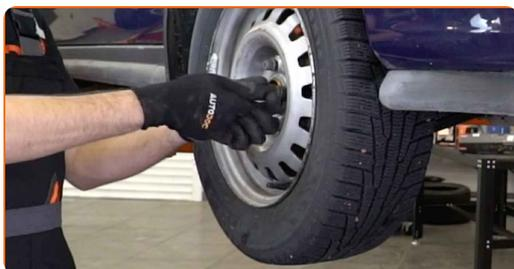
**26** Sänk bilen och arbeta i omvänd ordning, dra åt hjulbultarna. Använd en momentnyckel. Dra åt den till 110 Nm vridmoment.
