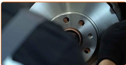
**18** Dra åt bromsskivans fästelement. Använd Torx T30. Använd en momentnyckel. Dra åt den till 7 Nm vridmoment.
