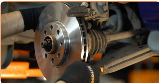
**21** Behandla bromsokets fäste där det ansluts till bromsklossarna. Använd anti gnissel pasta.
