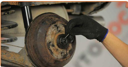
**25** Installera navlagrets skyddslock. Använd en gummihammare.
