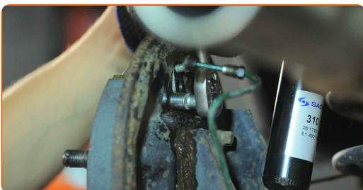
**18** Fäst bromsröret. Använd en öppen ringnyckel #10.
