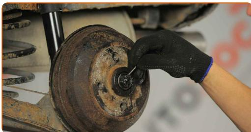
**25** Installera navlagrets skyddslock. Använd en gummihammare.
