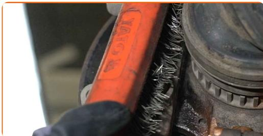
**15** Skruva loss fästelementen från bromsokets anordning. Använd HEX Nr. H10. Använd en spärrnyckel. Använd en trycknyckel.
