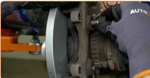
**25** Dra åt bromsokets anordning. Använd HEX Nr. H10. Använd en momentnyckel. Dra åt den till 95 Nm vridmoment.
