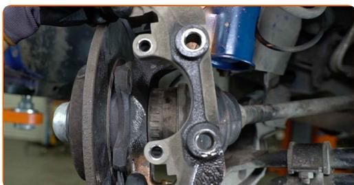
**17** Skruva loss bromsskivans fästelement. Använd en Phillips skruvmejsel. Använd en slagskruvmejsel.
