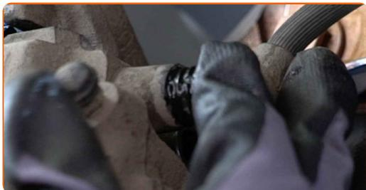
**32** Installera bromsokets spärrfjäder. Använd en kofot.
