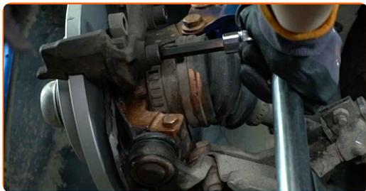
**26** Behandla bromsokets kolv. Använd en rengöringsborste i nylon. Använd brake cleaner.
