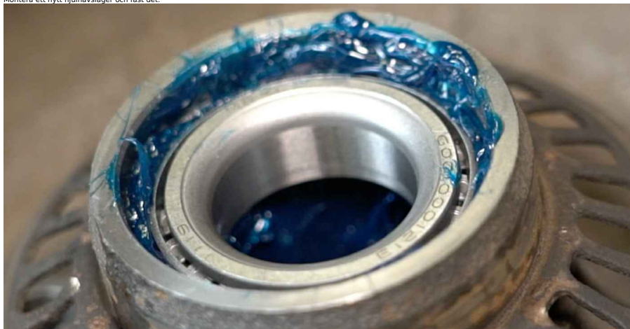
22 Montera hjullagrets oljepackning.
