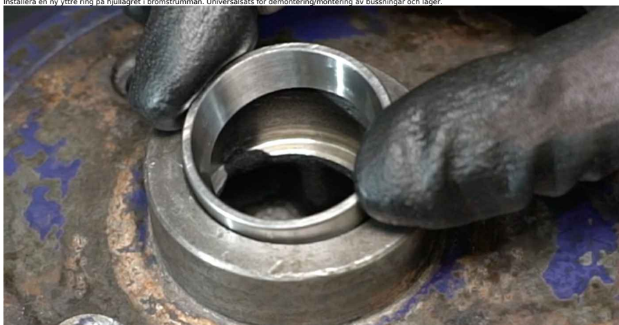
19 Montera hjullagrets nya inre ring i bromstrumman. Universalsats för demontering/montering av bussningar och lager.
