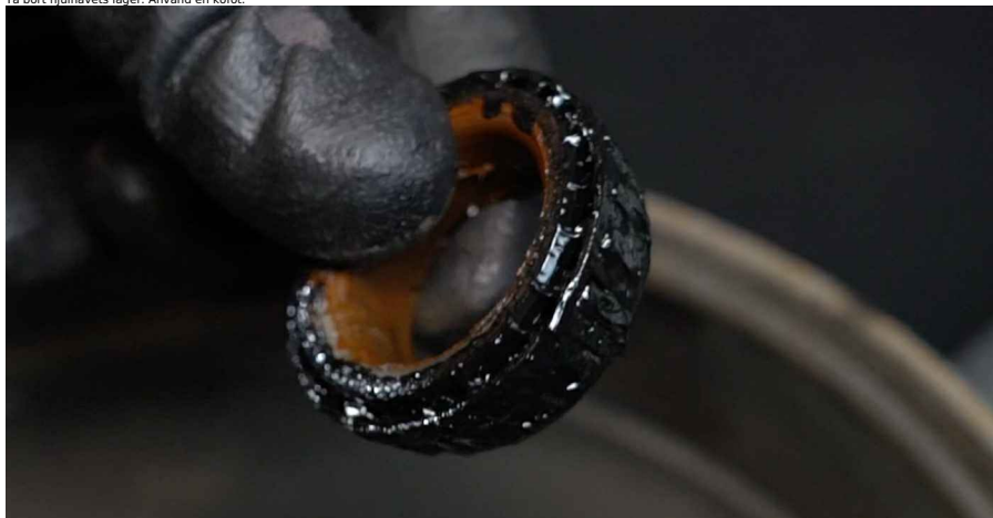
14 Gör rent navlagrets monteringsäte.
