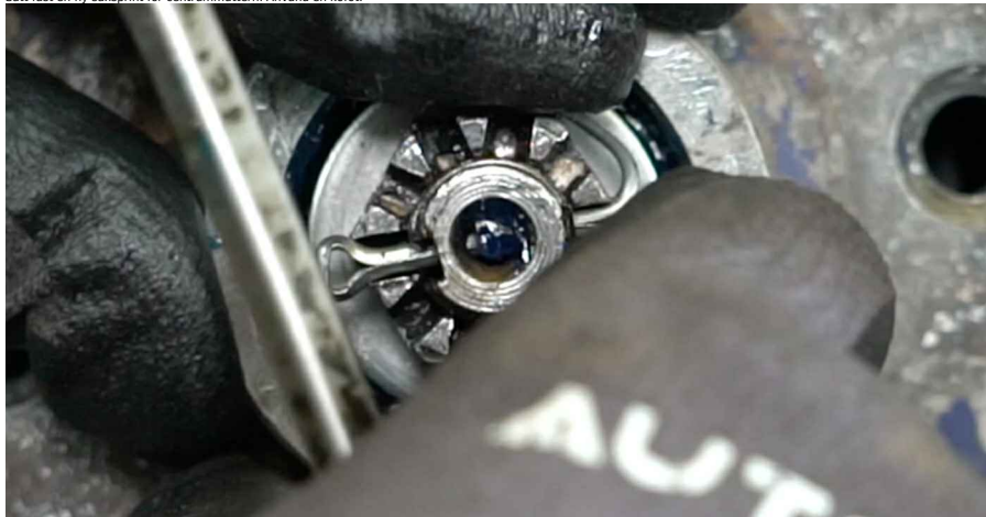
34 Installera navmutterns kapsel. Använd en gummihämmare.
