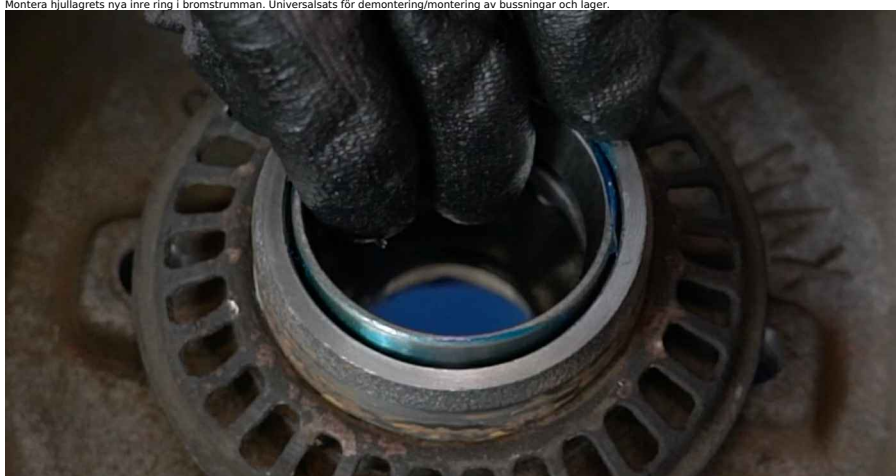
20 Behandla hjulnavlagret. Använd lagerfett.
