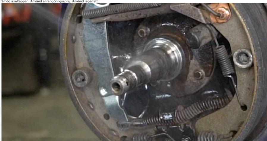
24 Installera bromstrumman som är monterad med hjulnavlagret.
