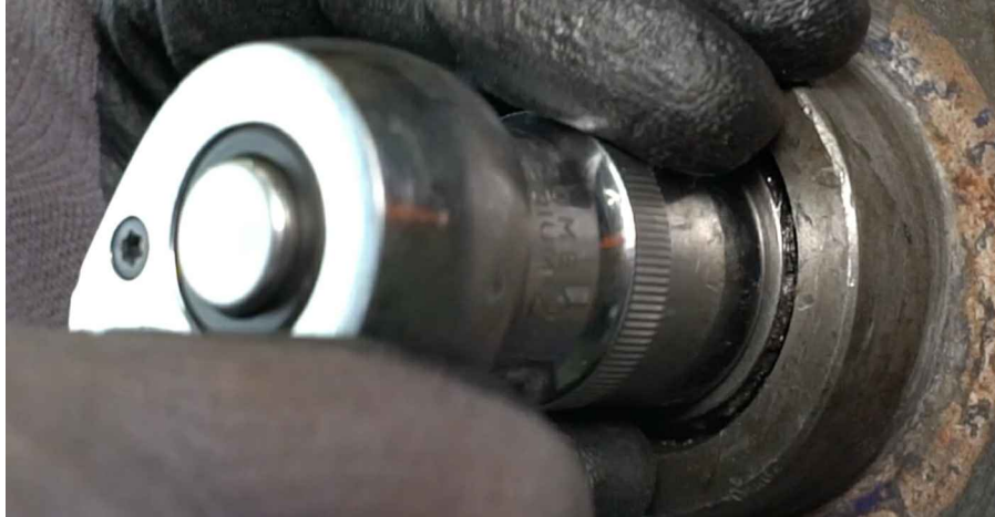
9 Ta bort hjullagerbricken. Använd en kofot.
