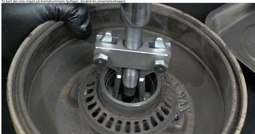
club.autodoc.se 6-14 16 Ta bort hjullagrets yttre ring från bromstrumman. Använd en universalsats för demontering/montering av bussningar och lager.
