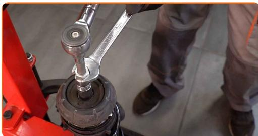
Utbyte: fjädrar – VAUXHALL Corsa Mk II (C) Hatchback (X01). Tips från AUTODOC:
