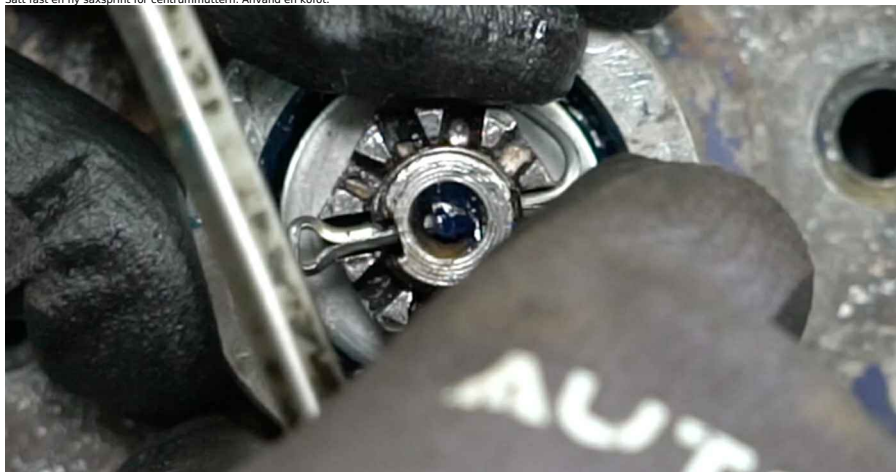
34 Installera navmutterns kapsel. Använd en gummihämmare.
