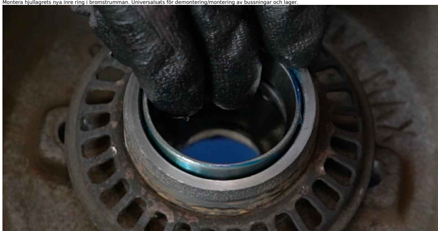
20 Behandla hjulnavlagret. Använd lagerfett.
