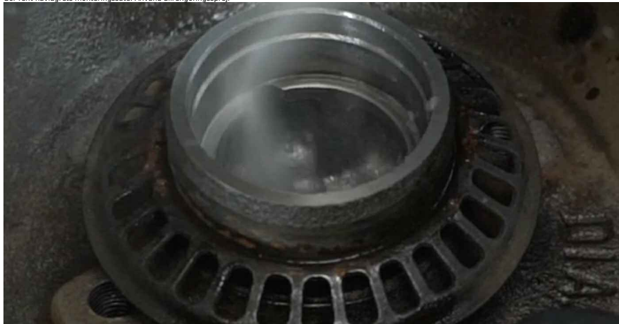
18 Installera en ny yttre ring på hjullagret i bromstrumman. Universalsats för demontering/montering av bussningar och lager.
