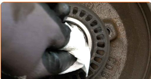
**15** Ta bort den inre ringen på bromsstrummans hjullager. Använd en universalavdragare.
