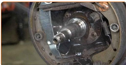
**24** Installera bromstrumman som är monterad med hjulnavlagret.
