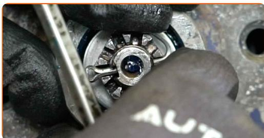
**34** Installera navmutterns kapsel. Använd en gummihammare.
