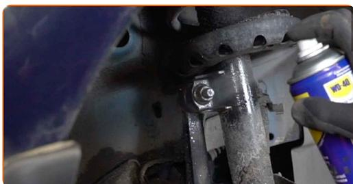
**12** Skruva loss muttern och avlägsna krängningshämmaren från stötdämparen. Använd kombinyckel Nr 19. Använd hylsnyckel Nr18. Använd en spärrnyckel.
