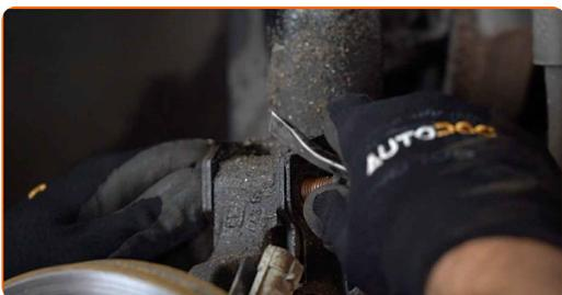
**16** Koppla loss bromsslangshållaren från fjäderbenet. Använd en plattmejsel.
