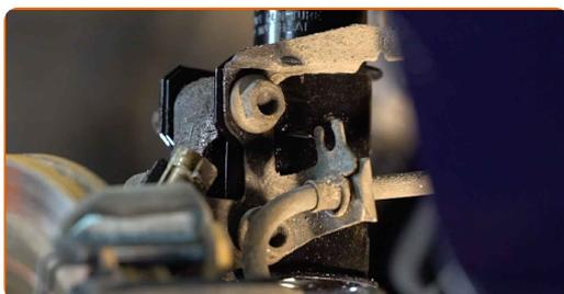
**37** Säkra krängningshämmlänken till fjäderbenet. Använd kombinyckel Nr19. Använd hylsnyckel Nr18. Använd en momentnyckel. Dra åt den till 65 Nm vridmoment.
