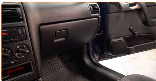
**2** Lägg en trasa under kabinfiltret för att skydda de invändiga delarna mot smuts.
