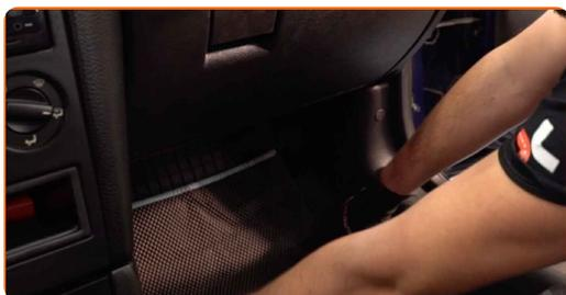
**3** Skruva loss handskfackets fästskruvar. Använd Torx T20.
