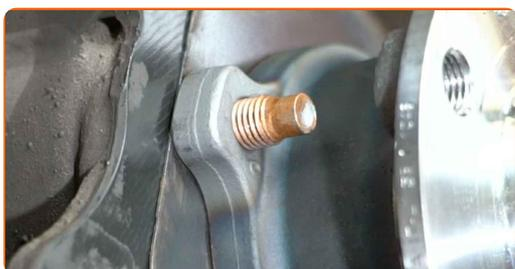
**33** Dra åt hjulnavets fästen. Använd Torx T55. Använd en momentnyckel. Dra åt den till 110 Nm vridmoment.
