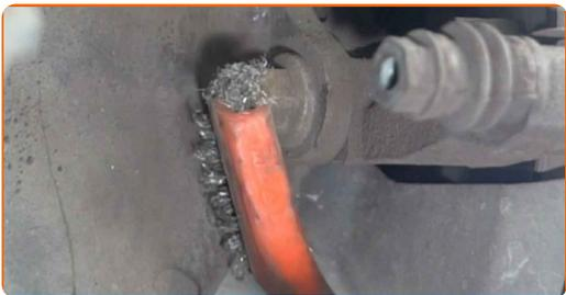
**12** Skruva loss fästena till bromsokshållaren. Använd hylsnyckel Nr15. Använd en spärrnyckel.
