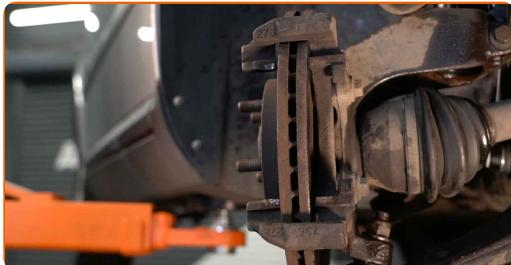
Utbyte: bromsbelägg – VOLVO V40 Skåpbil / Hatchback (525, 526). Tips:
