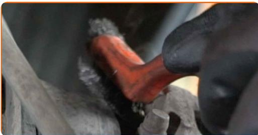
**10** Skruva loss bromsokets fästen. Använd kombinyckel Nr15. Använd hylsnyckel Nr13. Använd en spärrnyckel.
