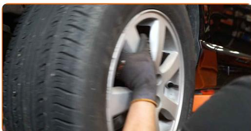
**9** Rengör bultarna till bromsoket. Använd en stålborste. Använd WD-40 aerosol.
