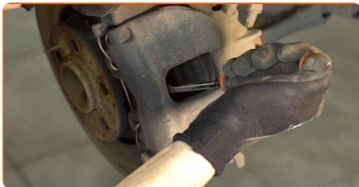
**8** Ta bort dammskyddskåporna från bromsokets styrstift. Använd en kofot.
