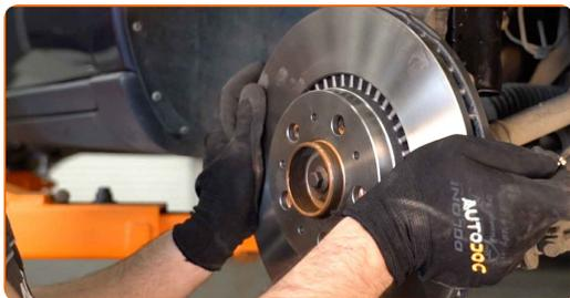
**21** Dra åt bromsskivans fästelement. Använd hylsnyckel Nr10. Använd en momentnyckel. Dra åt den till 9 Nm vridmoment.
