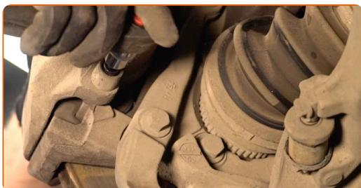
**10** Koppla av bromsokets fjäder. Använd en kofot.
