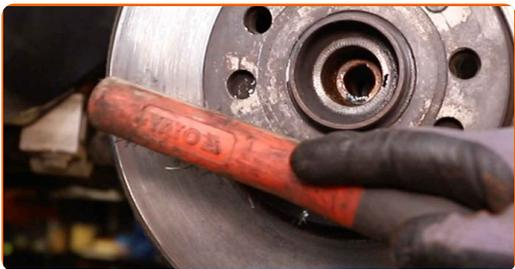
**16** Skruva loss bromsskivans fästelement. Använd Torx T30. Använd en slagskruvmejsel.
