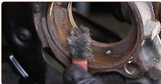
**28** Behandla hjulnavets monteringsfäste. Använd kopparpasta.
