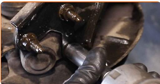
**15** Rengör bromsskivans fäste. Använd en stålborste. Använd WD-40 aerosol.
