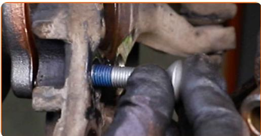
**31** Drag åt hjulnavets bultar. Använd XZN #12. Använd en momentnyckel. Dra åt den till 70 Nm vridmoment.
