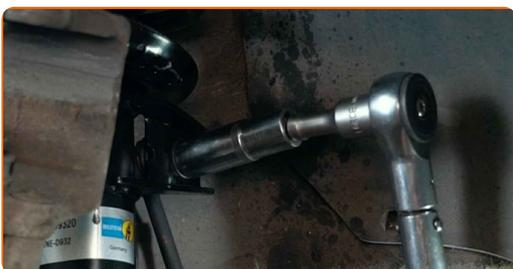
**55** Montera och dra åt drivaxelbulten. Använd hylsnyckel Nr27. Använd en spärrnyckel.
