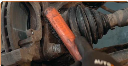
**18** Skruva loss fästelementen från bromsokets anordning. Använd hylsnyckel Nr21. Använd en spärrnyckel. Använd en trycknyckel.
