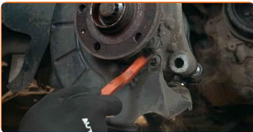
**24** Skruva loss bromssköldens fästen. Använd Torx T27. Använd en spärrnyckel.
