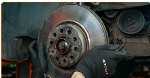
**23** Rengör bromssköldens fästen. Använd en stålborste. Använd WD-40 aerosol.
