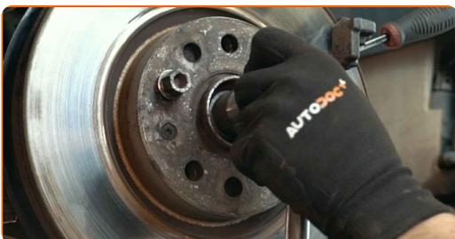
**17** Rengör bultarna till bromsoket. Använd en stålborste. Använd WD-40 aerosol.
