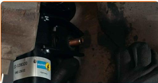
**54** Dra åt fästningarna som kopplar stabiliseringslänken till stötdämparen. Använd kombinyckel Nr 18. Använd hylsnyckel Nr18. Använd XZN #6. Använd en momentnyckel. Dra åt den till 55 Nm vridmoment.
