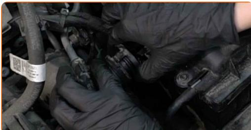
**4** Koppla bort vakuumslangen från luftfilterhöljet.
