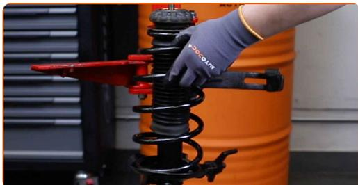
35 Rengör fästningssätena på stötdämparen. Använd en stålborste. Använd WD-40 aerosol.
