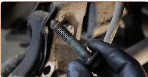
15 Koppla loss styrspindeln från fjäderbenet.
