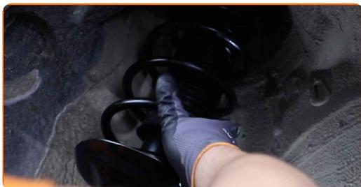
**37** Skruva i de övre fästena till fjäderbensätet. Dra inte åt den.
