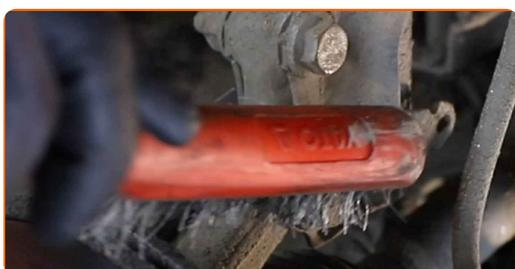
11 Skruva loss fästena som kopplar ihop fjäderbenet med styrspindeln. Använd kombinyckel Nr 18. Använd hylsnyckel Nr18. Använd en spärrnyckel.
