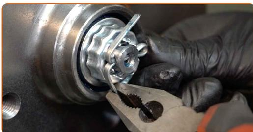
**16** Installera navmutterns kapsel. Använd en gummihammare.
