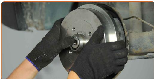
**26** Skruva i hjulnavets fäste. Använd kombinyckel Nr 24.
