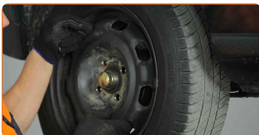
**7** Avlägsna navlagrets skyddslock. Använd en platt metall mejsel. Använd en hammare. Använd en plattmejsel.
