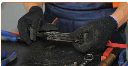
**17** Plocka loss mer av övre kvarhållningsfjäders och justeringsmekanismen. Använd en tång.
