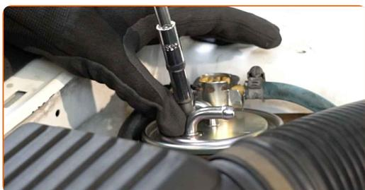
**16** Fyll det nya filtret med bränsle. Använd en handdriven sugpump.
