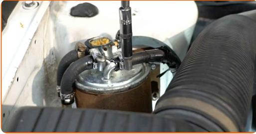
**6** Koppla ur bränslematarledningarna från bränslefiltret. Använd en rundtång.
