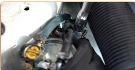
**5** Lossa på bränslematarledningarnas fästelement till bränslefiltret. Använd hylsnyckel Nr7. Använd en spärrnyckel.
