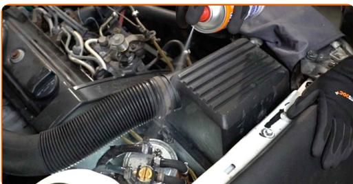
**4** Lossa på bränslefilterets monterning. Använd hylsnyckel Nr13. Använd en spärrnyckel.
