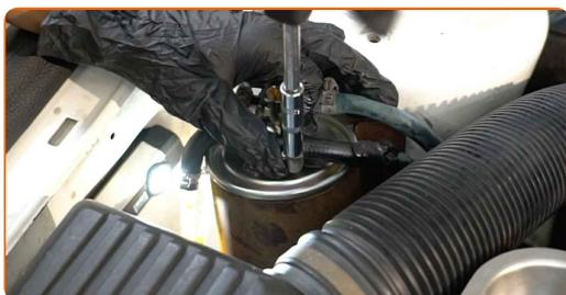
**19** Skruva i bränslefilterets monteringsfäste. Använd hylsnyckel Nr13. Använd en spärrnyckel.
