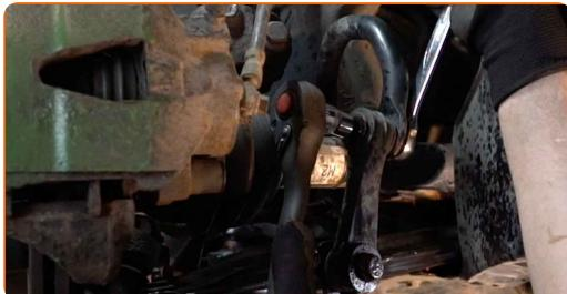
**8** Skruva loss fästelementet som förbinder krängningshämmaren med länkarmen. Använd hylsnyckel Nr16. Använd en spärrnyckel.
