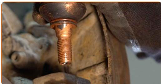
**15** Koppla tillbaka parallellstagsänden till styrspindeln.
