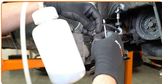
**25** Skruva loss skruven till bromsluftaren. Använd kombinyckel Nr 7.
