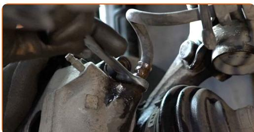
**13** Lossa fästet som ansluter bromsröret till bromsslangen. Använd kombinyckel Nr 11.
