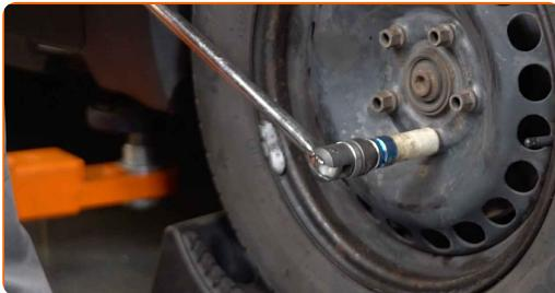
**4** Höj bilens främre del och säkra fästdelarna.
