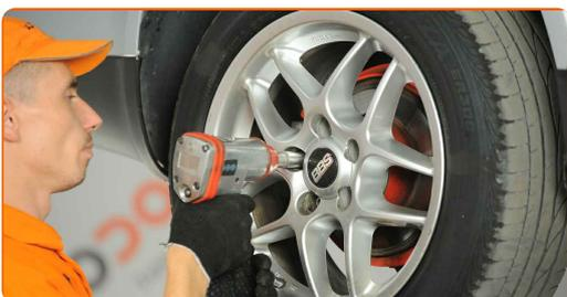
31 Sänk bilen och arbeta i omvänd ordning, dra åt hjulbultarna. Använd en momentnyckel. Dra åt den till 120 Nm vridmoment.
