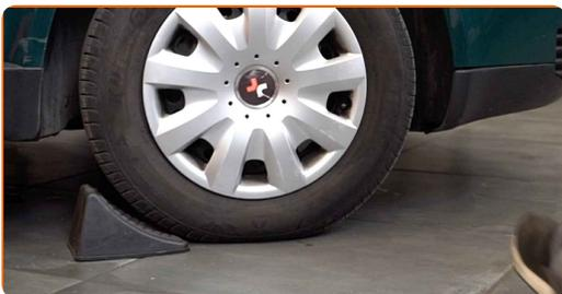
**2** Lossa på hjulmonterings bultar. Använd hjulmutterhylsor nr. 17
