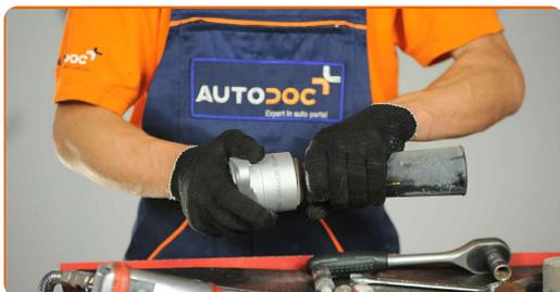
**17** Skruva fast tryckstångens övre fästelement på stötdämparen. Använd kombinyckel Nr 17. Använd en justerbar skiftnyckel. Använd en momentnyckel. Dra åt den till 25 Nm vridmoment.
