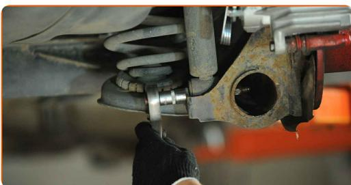
**8** Säkra bakre axelbalken. Använd en hydraulisk domkraft.
