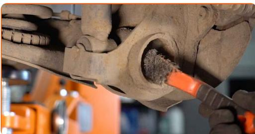
**7** Skruva loss de nedre fästelementen från stötdämparen. Använd kombinyckel Nr 16. Använd hylsnyckel Nr16. Använd en spärrnyckel.
