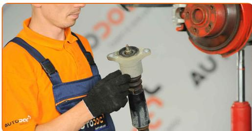
Utbyte: fjäderbenslagring – VW PASSAT (3B3). Tips från AUTODOC:
