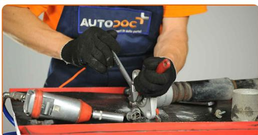
**18** Rengör stötdämparnas monteringsfästen. Använd en stålborste. Använd WD-40 aerosol.
