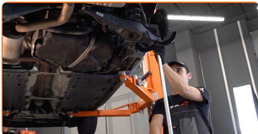
**Utbyte: fjäderbenslagring – VW Passat B7 Skåpbil / Kombi (365). Tips från AUTODOCs experter:**
