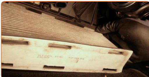
**Utbyte: kupéfilter – VW Passat B7 Variant (365). Tips från AUTODOCs experter:**
