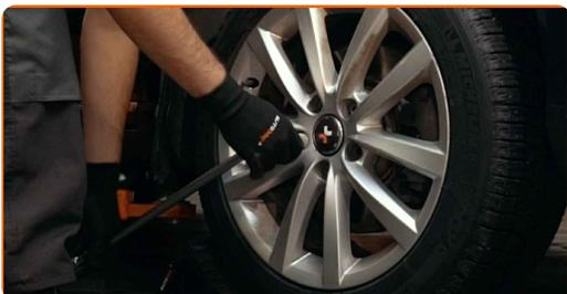
**10** Hög bilens främre del och säkra fästdelarna.
