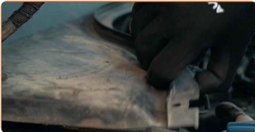
**6** Rengör fästelementen på det övre fästet på fjäderbenet. Använd en stålborste. Använd WD-40 aerosol.
