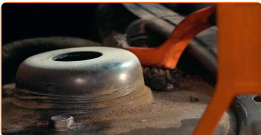
**7** Lossa de övre fästena på fjäderbenet. Använd hylsnyckel Nr13. Använd en spärrnyckel.
