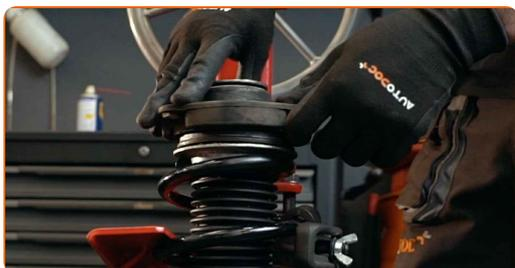
45 Dra åt muttern på stötdämparens kolvstång. Använd hylsnyckel Nr21. Använd HEX Nr. H7. Använd en momentnyckel. Dra åt den till 60 Nm vridmoment.
