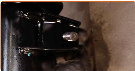
**69** Dra åt fästelementet på stabilisatorn. Använd hylsnyckel Nr18. Använd XZN #6. Använd en spärrnyckel.
