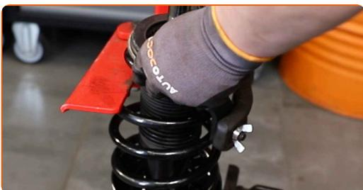
**47** Montera det övre stötdämparfästet tillsammans med genomslagsstoppet.
