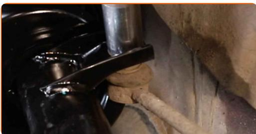
**70** Drag åt de undre fästena till fjäderbenet. Använd hylsnyckel Nr18. Använd XZN #14. Använd en momentnyckel. Dra åt den till 70 Nm vridmoment.+90°
