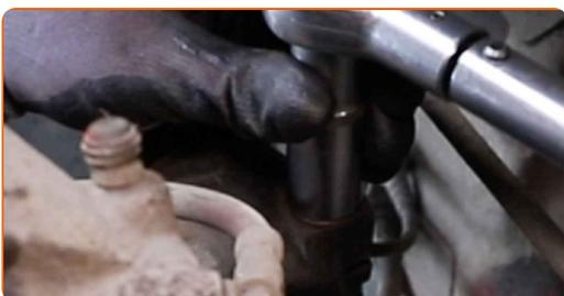
**71** Dra åt fästningarna som kopplar stabiliseringslänken till stötdämparen. Använd hylsnyckel Nr18. Använd XZN #6. Använd en momentnyckel. Dra åt den till 65 Nm vridmoment.
