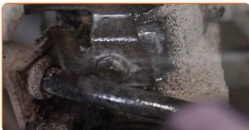
**20** Skruva loss fästet som ansluter bromsslangens hållare till fjäderbenet. Använd kombinyckel Nr 10.
