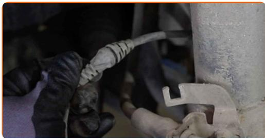
**19** Rengör fästet som ansluter bromsslangens hållare till fjäderbenet. Använd en stålborste. Använd WD-40 aerosol.
