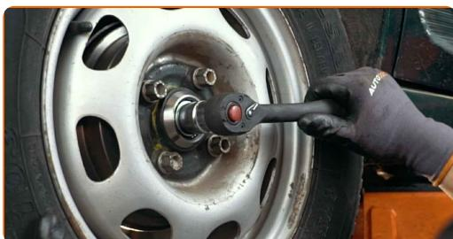
Utbyte: bromstrumma – VW Passat Variant (33B). Tips från AUTODOCs experter:
