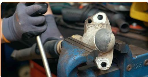
**20** Avlägsna skyddskåpan från stötdämparens montering. Använd en kofot.
