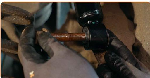
**34** Skruva in de lägre fästningarna för stötdämparen. Använd hylsnyckel Nr21. Använd en spärrnyckel.
