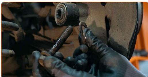
**16** Skruva loss övre fästelementet från stötdämparen. Använd hylsnyckel Nr16. Använd en spärrnyckel.
