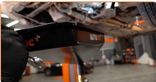
**8** Skruva loss dräneringspluggen. Använd HEX Nr. H17.
