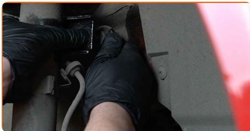
**15** Rengör ABS-kablagets konsol. Använd en stålborste. Använd WD-40 aerosol.
