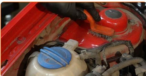
**4** Lossa på de övre fästena på stötdämparen fästningar. Använd hylsnyckel Nr13. Använd en spärrnyckel.
