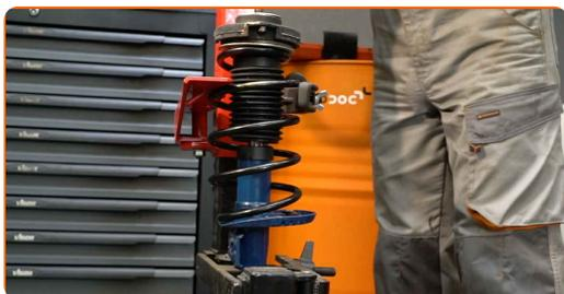
**45** Ta bort det monterade fjäderbenet.
