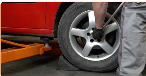
**8** Hög bilens främre del och säkra fästdelarna.
