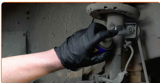
**13** Skruva loss fästena som håller fast krängningshämmaren med stötdämparen. Använd hylsnyckel Nr17. Använd en spärrnyckel.
