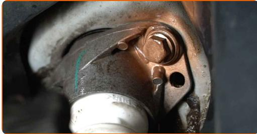
**29** Skruva åt fästena. Använd Torx T27.
