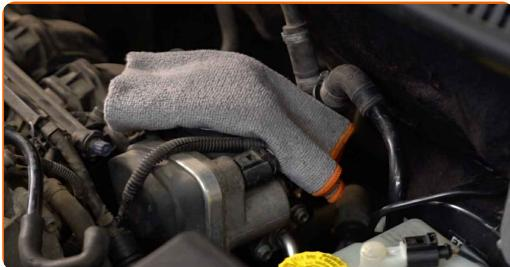
**6** Lossa fästsprövarna på luftfilterhållaren. Använd en Phillips skravmejsel.
