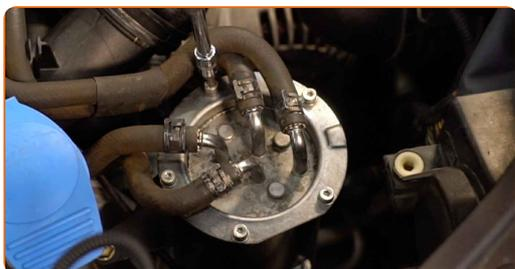
**5** Ta bort bränslefilterhöljets skydd. Använd en kofot.
