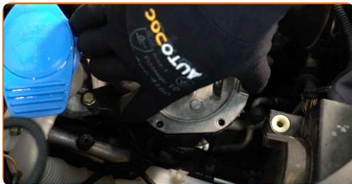
**13** Dra åt fästena på bränslefilterhöljets skydd. Använd Torx T20. Använd en momentnyckel. Dra åt den till 8 Nm vridmoment.
