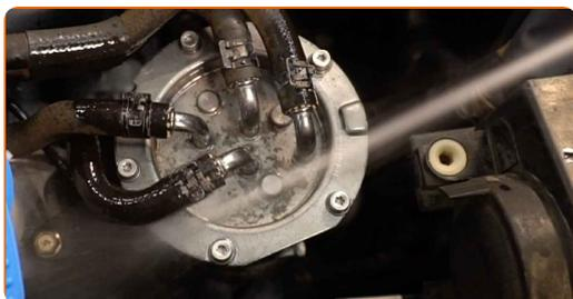
**4** Skruva loss fästena från bränslefilterhöljets skydd. Använd Torx T20.
