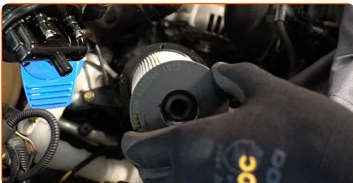
**Utbyte: bränslefilter – VW Scirocco III Skåpbil / Hatchback (137). Tips från AUTODOC:**
