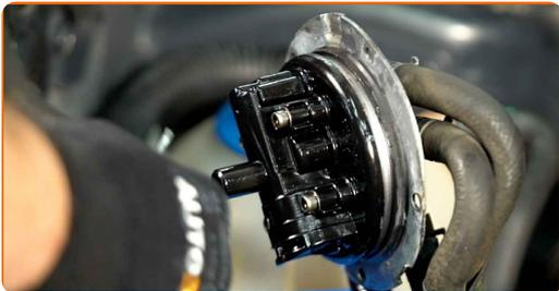
**10** Installera den nya tätningssringen. Använd en plattmejsel.
