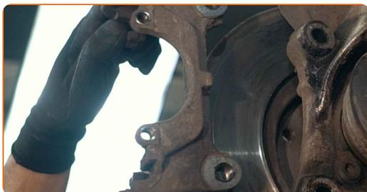
**19** Rengör bromsskivans fäste. Använd en stålborste. Använd WD-40 aerosol.
