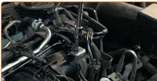
**4** Skruva loss olje påfyllningslocket.
