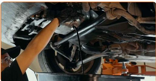
Utbyte: motorolja och filter – VW Sharan Skåpbil (7M). Tips från AUTODOCs experter:
