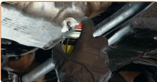
**16** Skruva i nya avtappningspluggen och dra åt den. Använd hylsnyckel Nr19. Använd en momentnyckel. Dra åt den till 30 Nm vridmoment.
