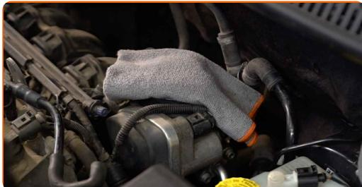
6 Demontera vevhusventilationens slang från oljepåfyllningsröret.
