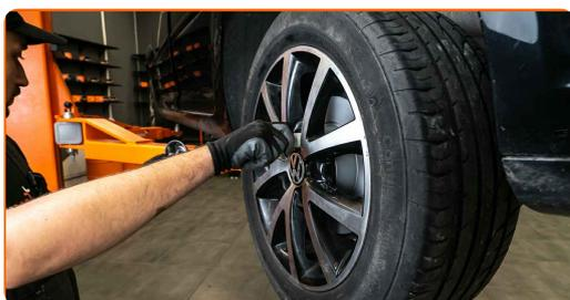
**24** Sänk bilen och arbeta i omvänd ordning, dra åt hjulbultarna. Använd en momentnyckel. Dra åt den till 120 Nm vridmoment.
