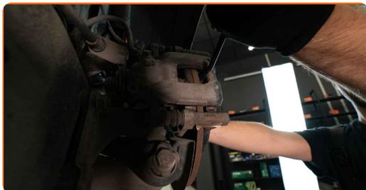
**9** Rengör bultarna till bromsoket. Använd en stålborste. Behandla bultarna till bromsoket. Använd WD-40 aerosol.
