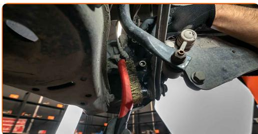
**10** Skruva loss fästelementen från bromsokets anordning. Använd XZN #14.
