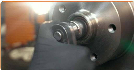
**30** Sätt fast en ny saxsprint för centrummuttern. Använd en hammare. Använd en kofot.
