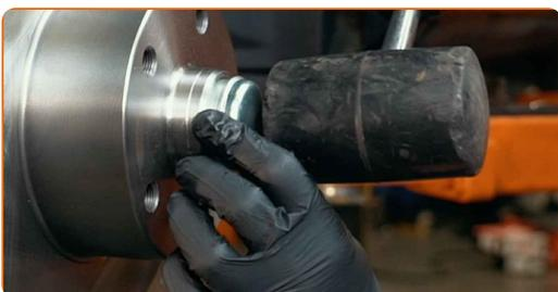
**32** Rengör bromsokets anordning från smuts och damm. Använd en stålborste. Använd brake cleaner.
