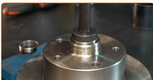
**25** Behandla hjulnavlagret. Använd en multi purpose smörjmedel.
