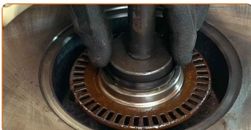
**27** Installera bromsskivan monterad med hjulnavslaget.
