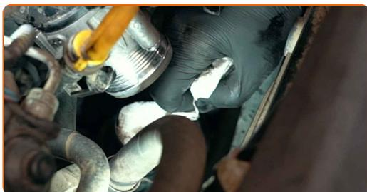
58 Rengör monteringsfästet för luftintagets slang. Använd allrengöringsprej.
