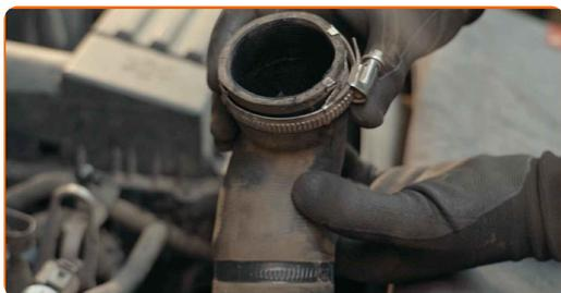
10 Täck över luftintagets slang med en mikrofiberduk för att skydda den från att smuts kommer in i systemet.
