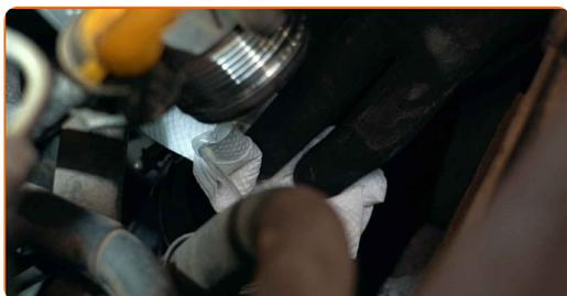
11 Skruva loss fästena som ansluter spjällhuset till insugningsröret. Använd Torx T27. Använd en spärrnyckel.
