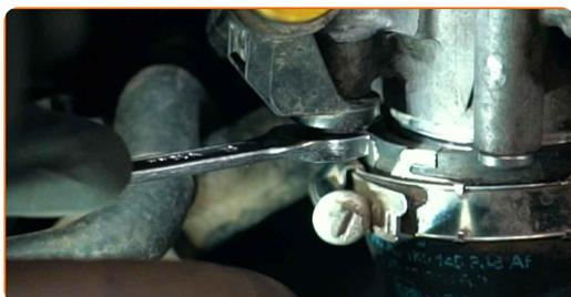
61 Säkra fästningarna för luftfilterkanalen. Använd hylsnyckel Nr7. Använd en spärrnyckel.
