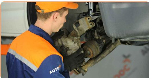
**78** Koppla loss kulledeet från styrspindeln.
