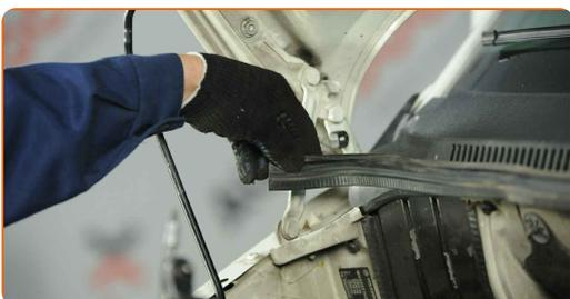
**36** Skruva loss bultarna till skyddskåpan. Använd Torx T30. Använd en spärrnyckel.
