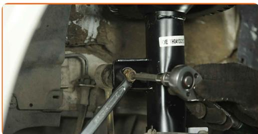
**90** Koppla tillbaka parallellstagsänden till styrspindeln.
