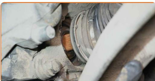
**83** Koppla kulledeet till styrspindeln.
