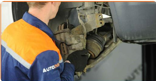
**25** Koppla kulleledet till styrspindeln.
