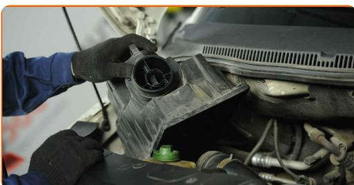
**70** Anslut luftinsugsröret till luftfilterhuset.
