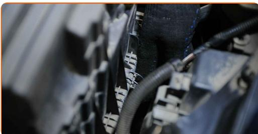
**31** Ta loss slangklämman på luftintaget. Använd Clic-R-klammertänger.
