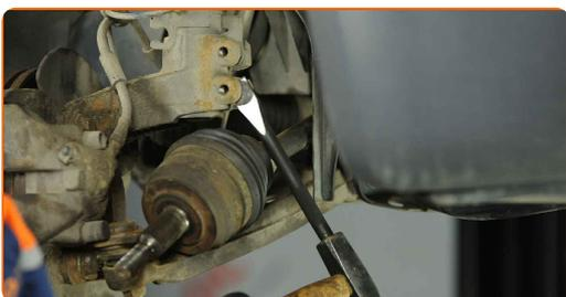
**24** Koppla loss styrspindeln från fjäderbenet.
